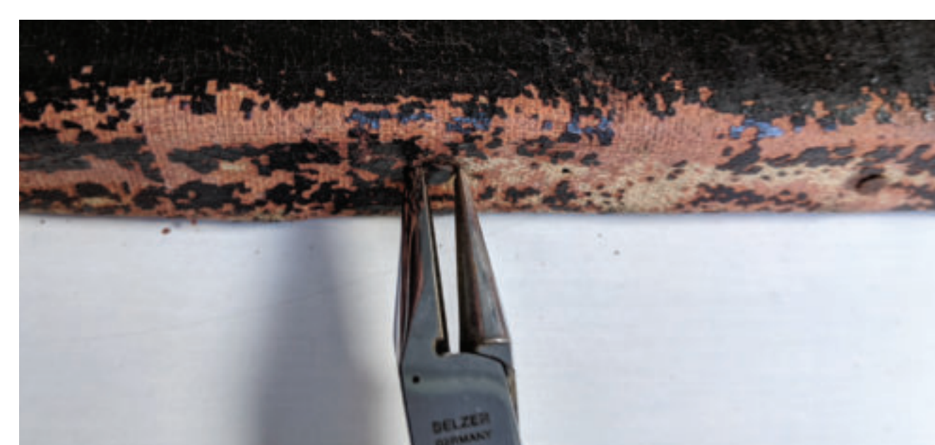
Eine Zange aus der Goldschmiede wurde mittels Kerbe modifiziert und sorgte für ein zerstörungsfreies und schnelles Entfernen der Nägel
