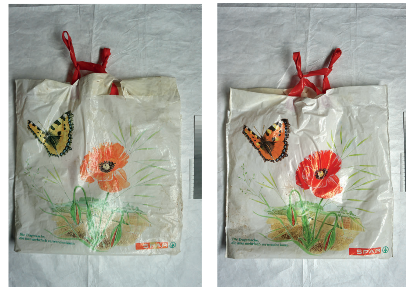
Es zeigen sich deutliche Unterschiede zwischen der nach außen und der nach innen ausgerichteten Seite der Tragetasche. Die weißen Bereiche der Außenseite sind vergilbt. Im Gegensatz dazu erscheint die Innenseite deutlich farbintensiver und hat weniger Risse.
