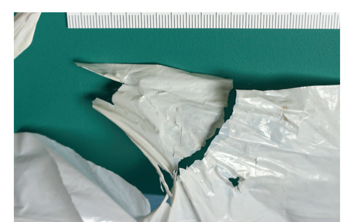
In die Fehlstellen wurden Intarsien aus natürlich gealtertem PE gesetzt. Auf eine farblich integrierende Retusche wurde verzichtet.
