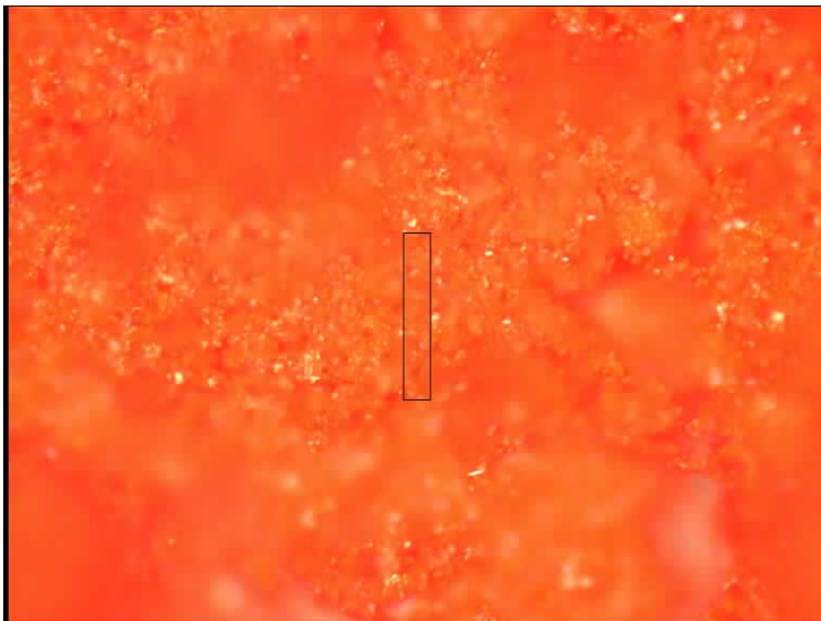
Abb.: 6.11: Mischprobe Zinnober/Mennige 1:10, mikroskopische Aufnahme. Der abgebildete Rahmen ( 2 \times 10\mu\text{m} ) dokumentiert das Messfeld.
