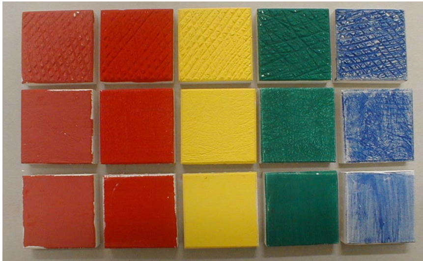
Abb. 5.1: Probekörper für UV-VIS-Versuche: von links nach rechts: Zinnober, Alizarin-Krapplack, Cadmiumgelb, Chromoxidhydrat-grün und Azurit. Von oben nach unten: Oberflächenrauigkeiten grob, rau und glatt.
