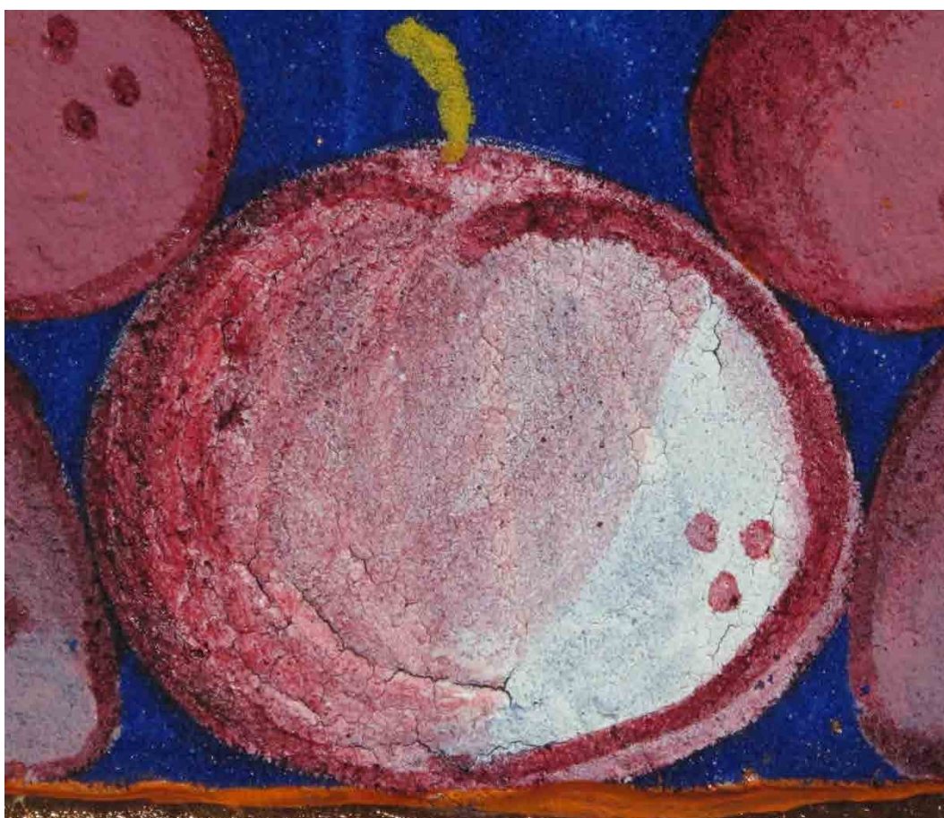
Abb. 450: Maltechnische Kopie eines Füllungspaneels des Dresdner Damaskuszimmers, in der weißen Farbe (Bleiweiß in Eiweiß) haben sich die gleichen Risse gebildet wie auf der originalen Oberfläche, vgl. Abb. 449
