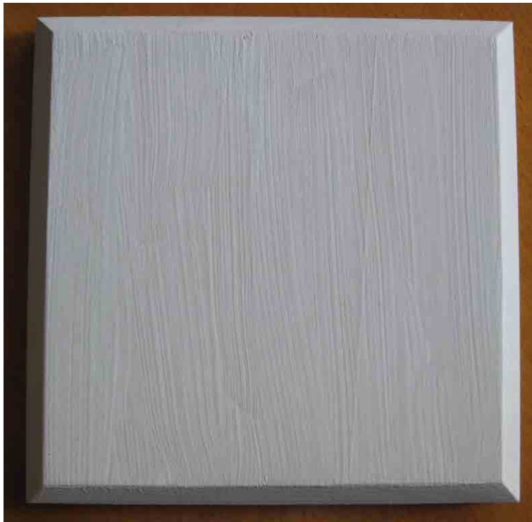
Abb. 443: Weiße Grundierung aus 7% Hasenhautleim (Fa. Kremer) und ungebranntem Gips (Lenzin Fa. Kremer), 65°C, einmal aufgestrichen
