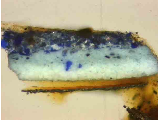
Abb. 361: Querschliff A26, Normallicht, Aleppo-Zimmer, Berlin, Füllungspaneel B4, blaue Blume auf Zinnfolie mit gelbem Lack, vgl. Untersuchungsprotokoll A26 im Anhang
