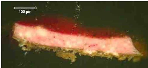
Abb. 389: Querschliff N9-4, Normallicht, Probe von einer rosa Blüte mit dunkelroter Umrisslinie, Untergrund Zinnfolie
