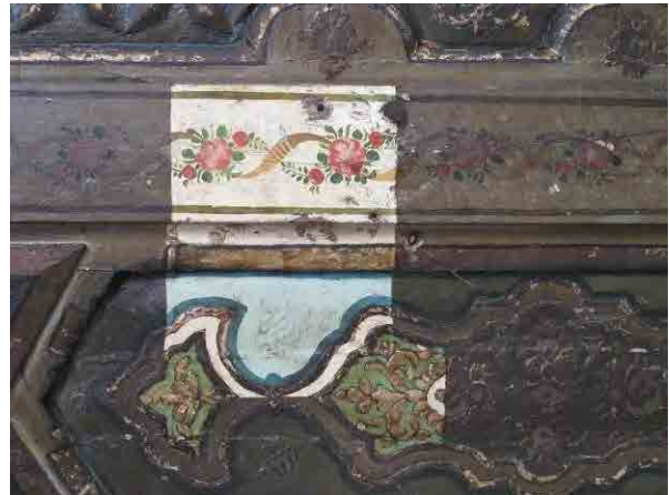
Abb. 611, Abb. 612: Bait Salīm al-Quwatlī, Kat. Nr. XVIII-408, Raum im EG des Ostflügels, Proben zur Abnahme der Rußbeläge, ausgeführt von Shadi Khalil, März 2010
