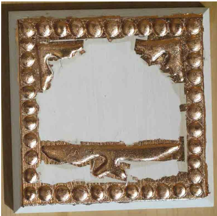
Abb. 445: Blattkupfer, angeschossen mit 3h Anlegeöl der Fa. Lefranc
