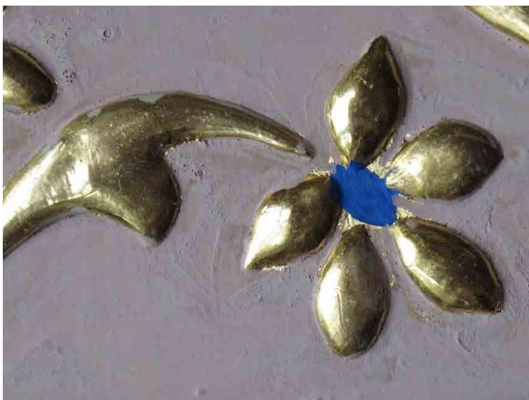
Abb. 335: vergoldetes Pastiglia-Motiv, Rekonstruktionsversuch mit 12%igem Hasenhautleim als Bindemittel für die Pastiglia-Masse (Füllstoff: Lenzin, Fa. Kremer), mit Wasser benetzt und vergoldet, mit Achat auf Hochglanz poliert
