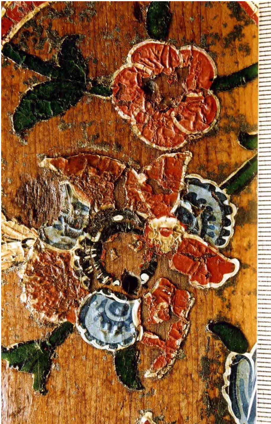
Abb. 606: Aleppo-Zimmer, Museum für Islamische Kunst, Berlin, Paneel B4, verschiedene Schadensbilder bei den Farben, Hintergrund völlig verputzt, ursprünglich Zinnfolie auf harzigem Anlegemittel mit gelbem Harzlack überzogen, totale Verputzung von Zinnfolie einschließlich des gelben Lacks, beide Lagen sind mit harzhaltigem Bindemittel ausgeführt und durch aggressive Lösemittel bzw. Abbeizer entfernt worden
