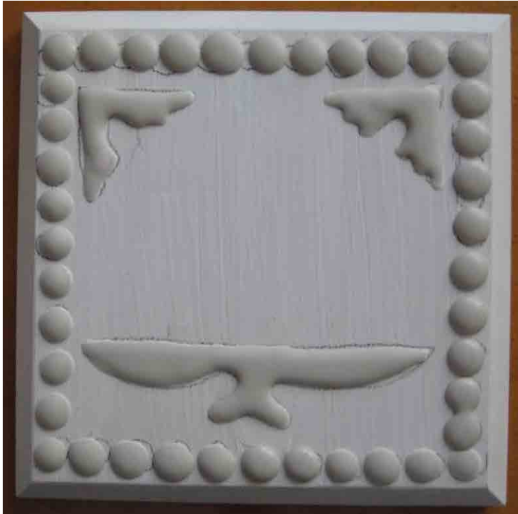
Abb. 444: Pastiglia-Verzierungen, 12 %iger Hasenhautleim, aufgefüllt mit 165 g Lenzin per 100 g Leimlösung
