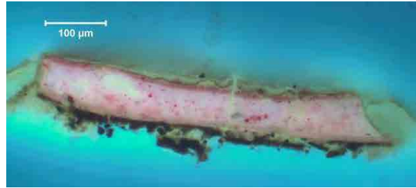
Abb. 389: Querschliff N9-4, Normallicht, Probe von einer rosa Blüte mit dunkelroter Umrisslinie, Untergrund Zinnfolie
